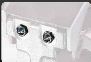
**7** Appoggi scorrevoli con punte di bloccaggio intercambiabili. Griffe in fusione più alte per un migliore bloccaggio del cerchio dall'interno e dall'esterno. **7** *Sliding supports with interchangeable clamping zones. Taller cast clamps for better rim clamping from inside and outside.*
