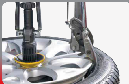
Procedura di smontaggio del tallone superiore Top bead demounting procedure
