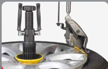
Procedura di smontaggio del tallone superiore Top bead demounting procedure
