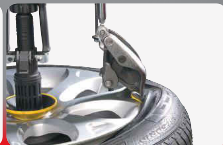
Procedura di smontaggio del tallone superiore Top bead demounting procedure
